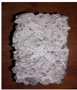
Corpo de prova após 7 dias de cura do concreto, superfície inferior
