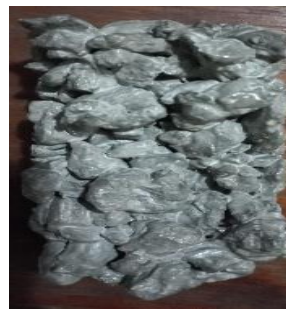
Corpo de prova após 7 dias de cura do concreto, superfície superior
